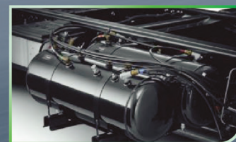
Phanh khí nén toàn phần (3) Full-air brake with air dryer (3)
