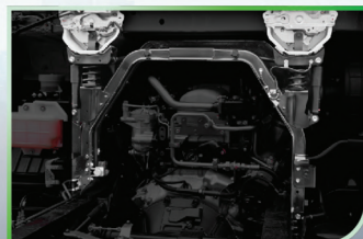
Hệ thống treo cabin toàn phần (2) (Mới) Full-floating cab suspension system (2) (New)
