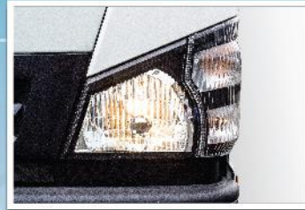
Đèn halogen phản quang đa điểm Multi-point reflector Halogen headlamp
